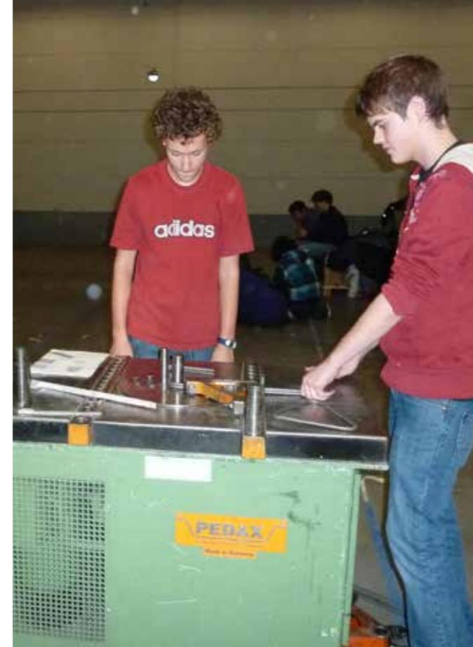
Bild links: Für die Armierung werden Eisenstäbe gebogen.
